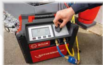
Funkcija samočišćenja za potpuno pražnjenje rekuperatora
